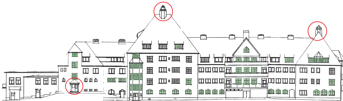
Norra fasaden med original- samt äldre fönster grönmarkerade och värdefulla detaljer rödmarkerade.
